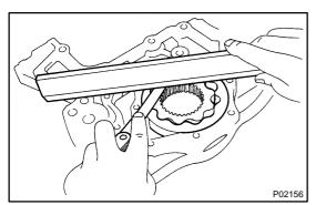
(d) Inspect the rotors for the side clearance.
