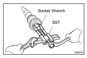
(d) If necessary, remove the side race.
