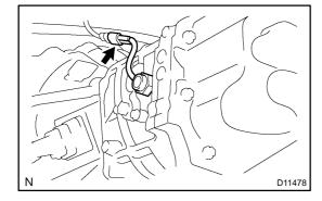
6. CONNECT BACK-UP LIGHT SWITCH CONNECTOR
