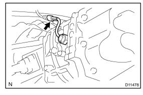
18. DISCONNECT BACK-UP LIGHT SWITCH CONNECTOR
