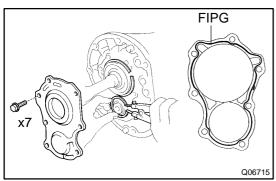
8. REMOVE FRONT BEARING RETAINER AND BEAR-ING SNAP RING
