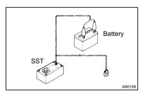
(d) Check functioning of the SST (See step 1-(a) on page RS-17).
